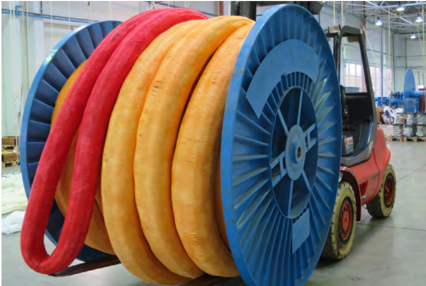
Dynlce Deep stroffa fyrir uppsetningu á vindmyllu undirstöðum. Slitpólið er 2.210 tonn og lengdin 61m.
