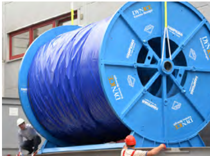
Afhending á 6.100 metra löngum 56mm Dynlce Warp djúpsjávarkaðli með 209 tonna slitstyrk.
