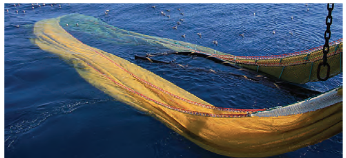
Dynlce Quicklines trollpoki skila jafnari stærð á fiski og heldur honum lífandi inn á dekk.
